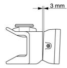
Spaltmaß am Drehgelenk zwischen Zugmaul und Flanschbund bei leichter Belastung des unteren Lappens in Fahrposition: max. 3 mm
